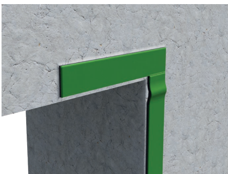
Figure 15 : Traitement des angles
