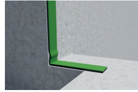
Figure 11 : Positionner ensuite la bande verticale en appliquant le principe de la surlongueur
