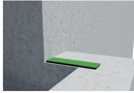
Figure 10 : Positionner la bande perpendiculaire à la largeur de l'appui
