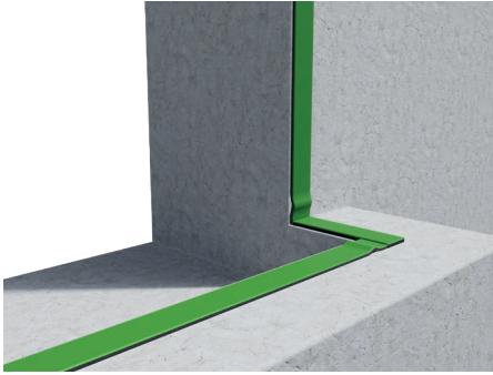
Figure 9 : Appui avec rejingot déporté
